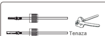
Figura 5.15 Engarce el pin de contacto al cable
